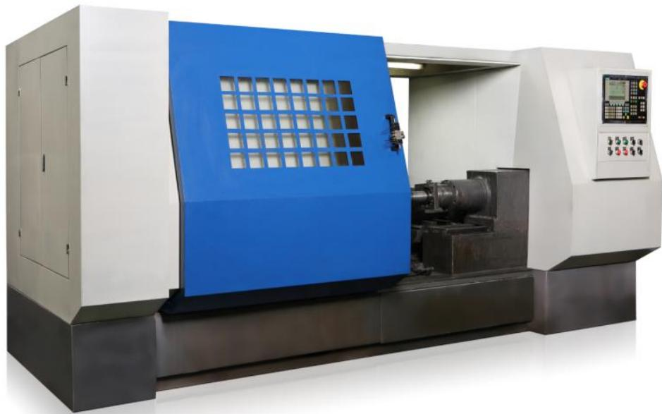
什么是轮毂数控旋压机？轮毂数控旋压机属于重型数控旋压机，主要应用于汽车轮毂制造如高档轿车、沙滩车、跑车、特种车、改装车、摩托车及电动车轮毂制造。设备为自动化控制设备，在生产制作过程中，除了上料和下料需要人工操作外，其它制作过程均由程序控制完成。该设备主控系统采用西门子802系列，由尚晞数控科技有限公司预置编制程序。旋轮进给系统为我司自主研发的高精密数字液压油缸，该系统精度高，体积小吨位大调试操作简便。
